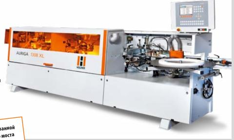
Опционально с моторизованной настройкой прижимного моста
