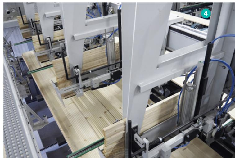
stellt die Werkstücke automatisch hochkant und positioniert diese, damit ein korrekter Mittelschnitt erfolgen kann. Das fertig geschnittene Holz gelangt entweder in Richtung der Hobelanlage oder mittels eines Bypasses an der Hobelmaschine vorbei direkt in die Paketierung. „Damit lässt sich die Anlage sehr flexibel auch nur zum reinen Auftrennen mit der Profisplit nutzen“, erklärt Weinig-Repräsentant Peter Haas.
