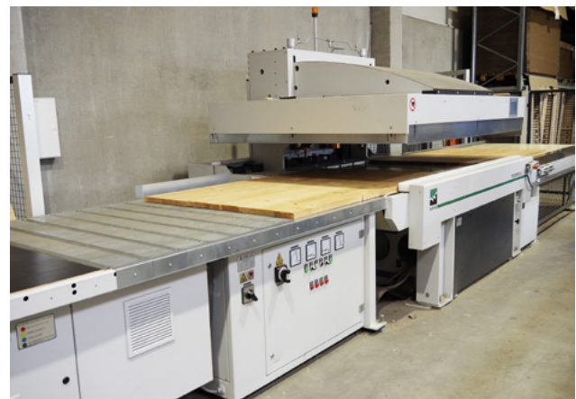
Die fertig verpresste Platte wird austransportiert, gleichzeitig gelangt die nächste in die Presse von Weinig Dimter
