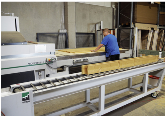
Der Mitarbeiter legt die belemten Lamellen auf den Aufgabetisch und stellt so die Platte zusammen
