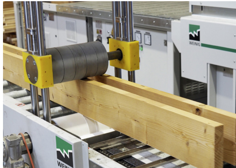
Die Lamellen werden stehend durch den Klebstoffauftrag transportiert, unten befindet sich die Leimwalze
