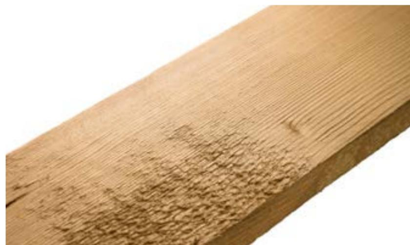
Roughness+ Sensoren für die Erkennung von ungehobelten Stellen auf zwei Seiten. Für einige Anwendungen müssen ungehobelte Stellen als Fehler betrachtet werden. In diesem Fall liefern unsere Sensoren gute Ergebnisse. Ungehobelte Stellen können damit erkannt und gekappt oder gesondert bewertet werden.
