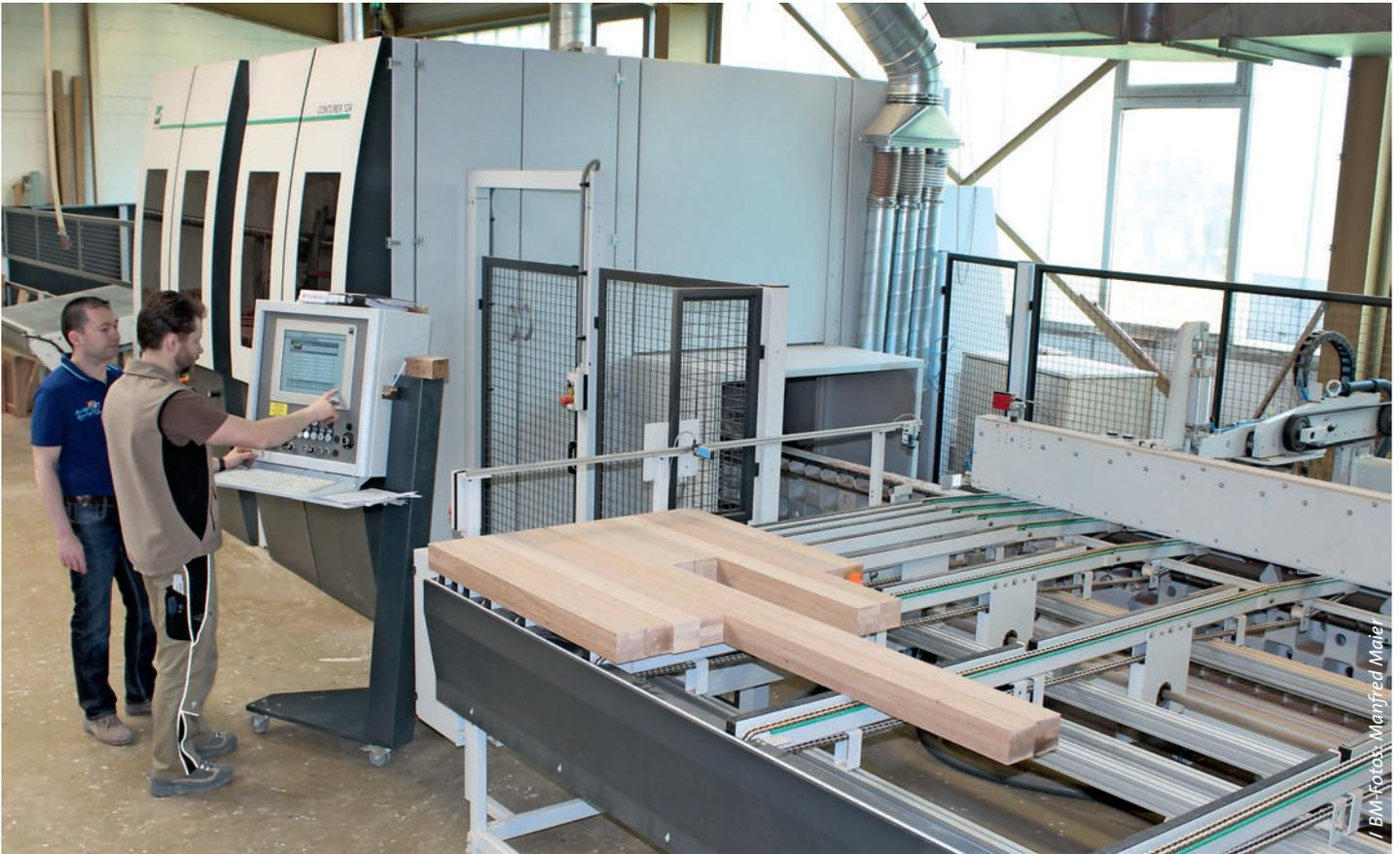
/ Die neue hochflexible Fertigungsbasis bei der Firma Östringer: Der Conturex C 124 leistet die Komplettbearbeitung von Rahmenteilen in einer Aufspannung inklusive Ein- und Auslaufmechanisierung für die mannarme Fertigung.
