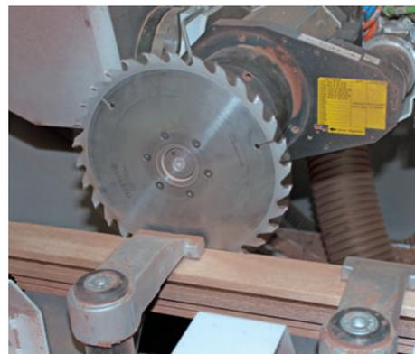
*/ ... Austrennen der Glasleisten mit der Säge. Dadurch werden zeitaufwendige zusätzliche Arbeitsschritte eingespart.*
