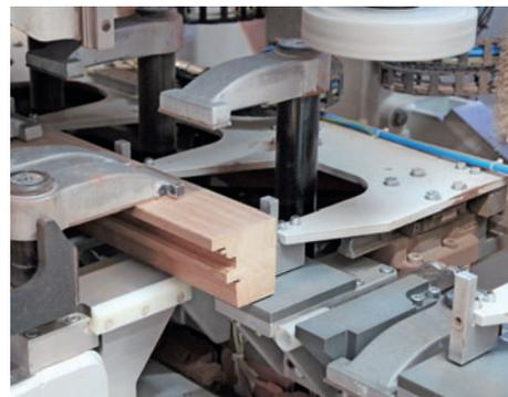
*/ Fliegender Wechsel: Die Powergrip-Zangen der beiden Bearbeitungstische übernehmen das Werkstück wechselweise für die sechsseitige Profilierung.*
