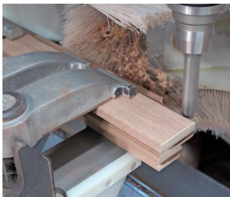
*/ In die Komplettbearbeitung auf dem Conturex voll integriert ist sowohl das Anfräsen als auch das anschließende ...*
