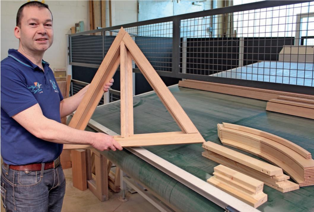
*I Auf alles vorbereitet: Manfred Östringer schätzt die nahezu unbegrenzten Bearbeitungsmöglichkeiten seines neuen Profilercenters. Der Conturex bearbeitet auch Schrägfenster, Rundbogensegmente und kürzeste Werkstücklängen.*
